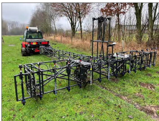
Figuur 33. Passieve non realtime oppervlakedetectie met het Vallon Multisondesysteem VXV16 en een staafdiagram waarop het maximale detectiebereik (m² - maaiveld) per kaliber is weergegeven.
